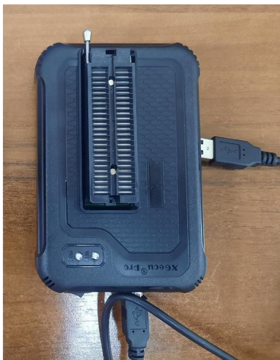
Рисунок 1 – Комплект оборудования для программирования
